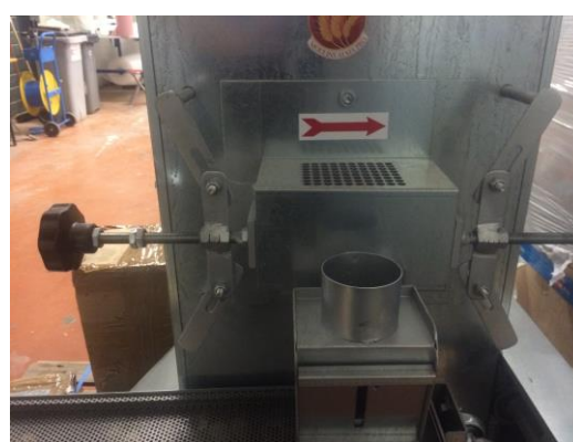
Réglage aisé des tampons contre le rouleau de décortiquage
