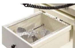
Les **tables support avec ventilation** permettent de produire des pâtes en continu sur de longues durées en les refroidissant sur le panier de réception.
