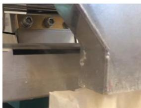
Un dispositif anti-poussière permet d'aspirer les poussières volantes pour maintenir un poste d'ensachage propre
