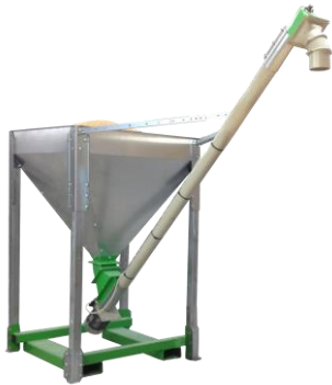
Exemple d'installation d'une trémie 750 litres avec vis de transport attenante + option de transport par chariot - élévateur (Moulin M70)
