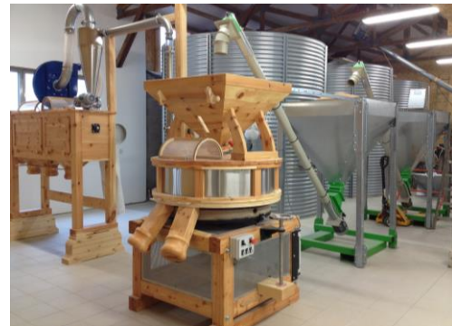
Exemple d'installation d'une trémie 750 litres avec vis de transport attenante + option de transport par chariot - élévateur (Moulin M70)
